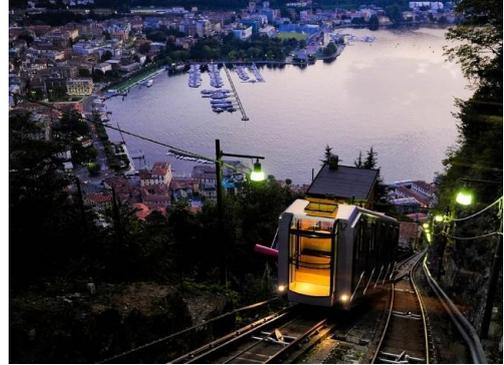
Le funiculaire est un parcours suggestif, tracé en ligne droite sur une pente vallonnée avec une pente maximale de 55% sur un rail de 1084 mètres, actuellement parcouru en 6 minutes et 30 secondes avec la possibilité de deux arrêts intermédiaires : Como Alta et Carescione sur demande des voyageurs.
